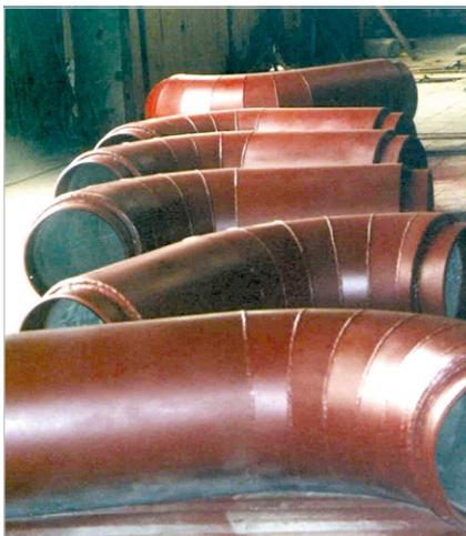
Отводы с износостойким материалом KALCRET для транспортировки угольной пыли на электростанциях
