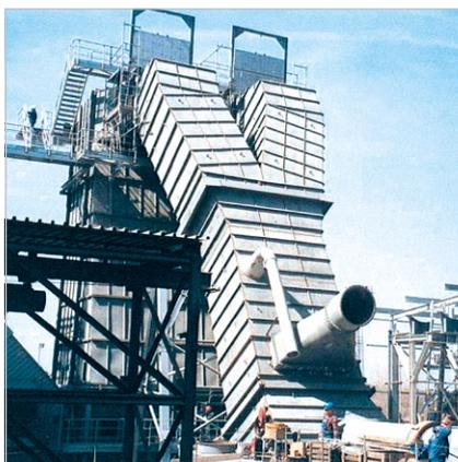
Футеровка трубы охладителя клинкера на цементном заводе с помощью износостойкого материала KALCRET. Фасонные элементы заводского изготовления с теплоизоляцией оснащены системой механического крепления.
