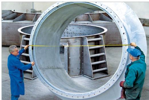
Футеровка сепаратора высокопрочным материалом KALCRET на цементном заводе; диаметр до 3 200 мм
