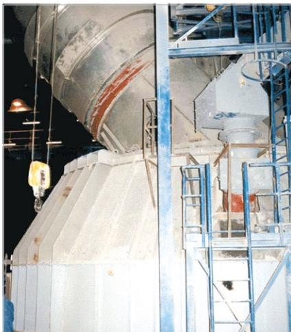
Футеровка дробилки сырьевой смеси на цементном заводе
