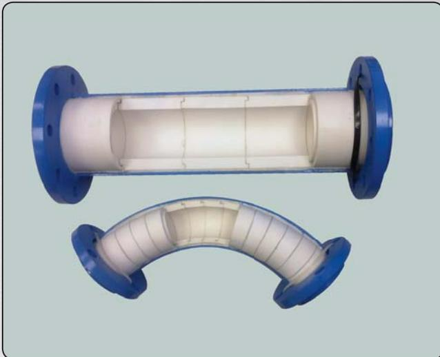
Трубы и отводы с внутренним диаметром керамики до DN 200 мм изготовлены из керамических цилиндрических сегментов типа "папа-мама" (см. фото слева вверху). При сборке это обеспечивает высокое качество соединения и длительный срок службы.
