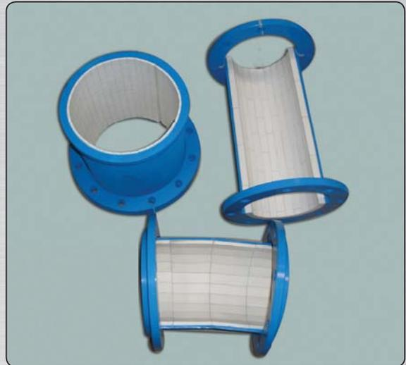
Трубы и отводы, внутренний диаметр которых превышает DN 200 мм, футерованы панелями (мозаикой) или конусными керамическими пластинами требуемой толщины. Конусные пластины подгоняются под диаметр трубы или отвода, облицованных керамикой.
