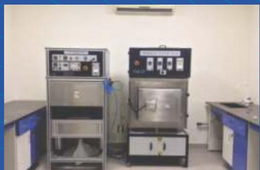
Стенды для испытаний сухим абразивом
