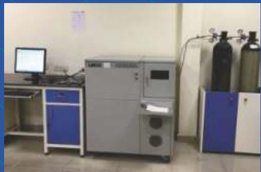
Спектрометр тлеющего разряда Leco
