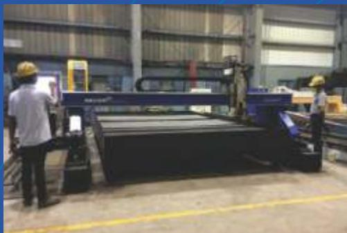
Плазменная резка на станке с ЧПУ
