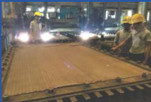
Процесс производства износостойких покрытий
