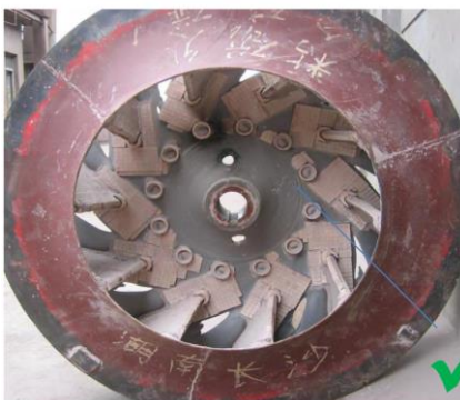
Зносостійка керамічна крильчатка після 3 років використання
