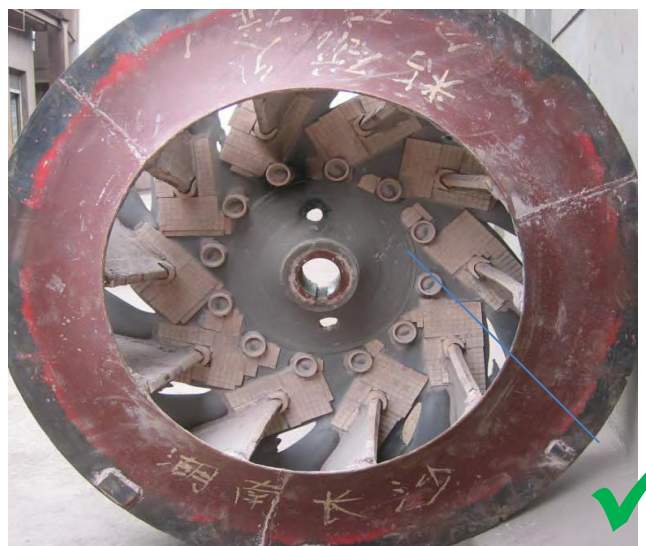
Зносостійка керамічна крильчатка після 3 років використання
